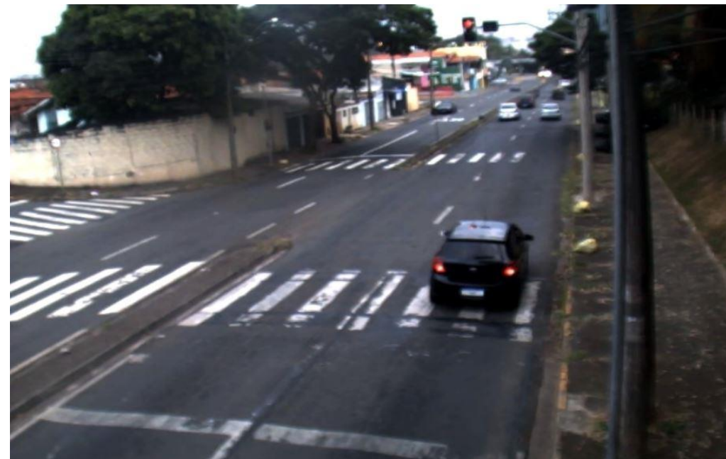
Foto 2: Detalhe do semáforo em vermelho e o veículo sobre laço intrusivo e a faixa de pedestres
